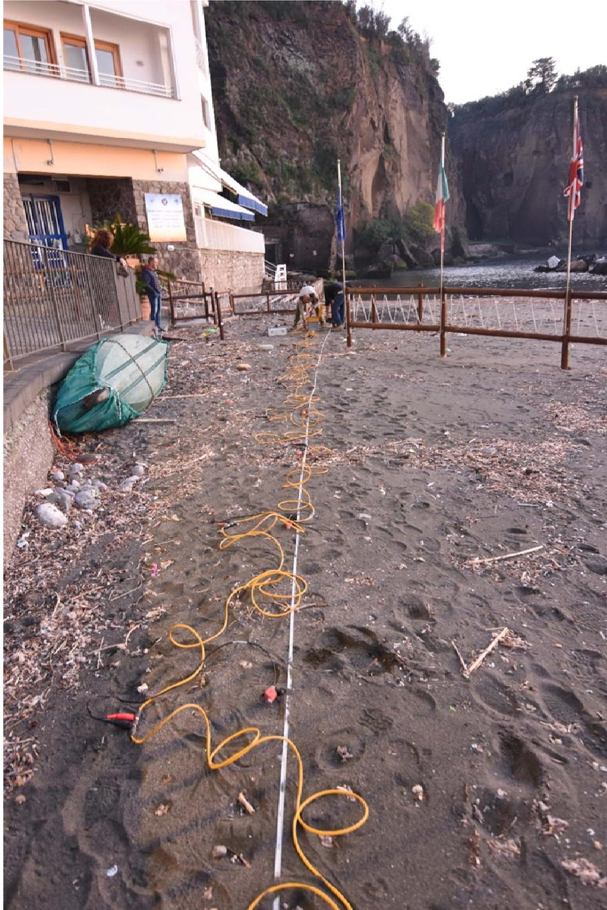
**Figura 3: Stendimento sismico MASW n.3.**
