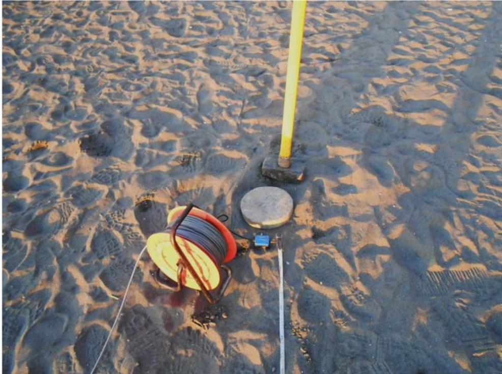
Figura 15: Sorgente energizzante, costituita da massa battente su piastra di alluminio. Lo starter/trigger è un geofono verticale Geospace a 14Hz.
