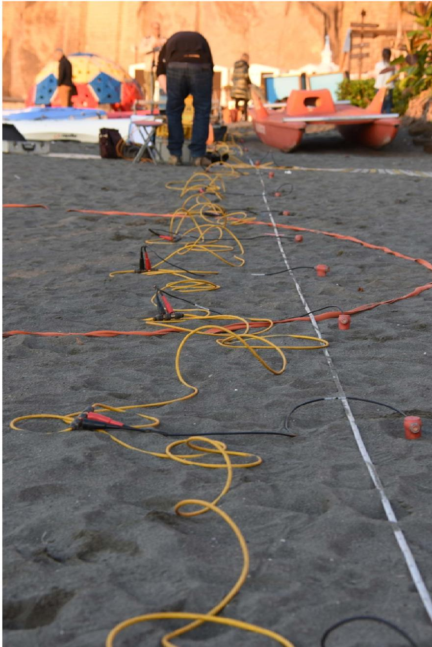
**Figura 2: Stendimento sismico MASW n.2.**
