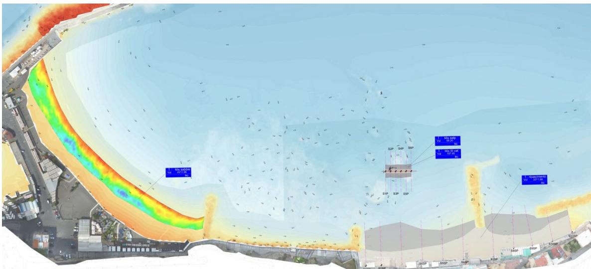
Schema progetto con indicazione dell'area di prelievo e di quella ricevente.
