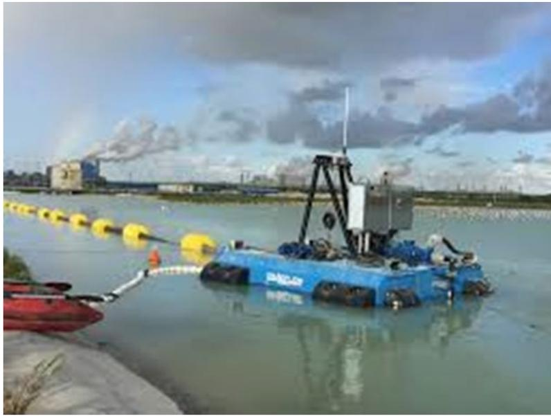
Figura 4 – Esempio della modalità di spostamento dei sedimenti con draga costituita da zattera galleggiante.
